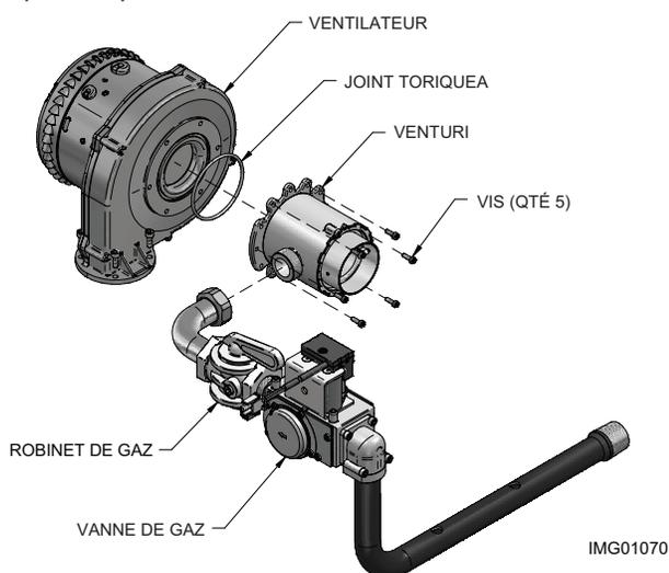
**Figure 2-2C** Modèle 1000 de venturi avec orifice pour propane liquide
