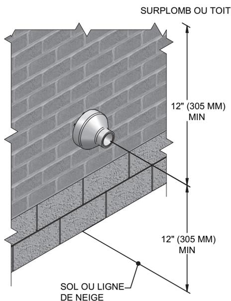
3. Découpez un (1) orifice (7 pouces (178 mm) de diamètre pour les installations n° 100140484) dans la structure pour installer le kit de terminaison.
